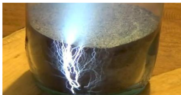
図11：放電チャネル（8倍速スロー再生）(Gable, 2018).
