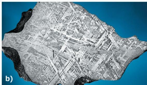
図41 鉄質隕石: a) Holsinger隕石(Canyon Diablo断片), b) Gibeon隕石, ナミビア, ウィドマンステッテン構造を示している。
