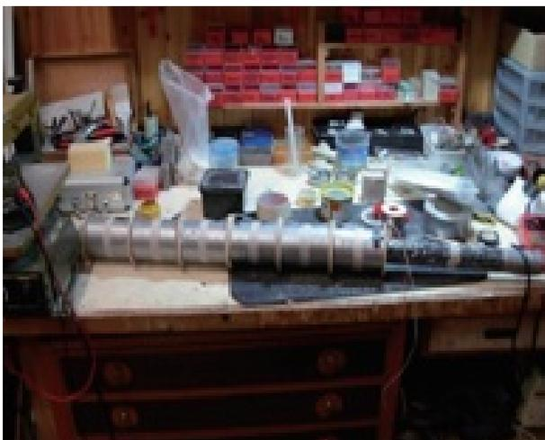
図6 非常に高いインダクタンスのアンテナの写真。6つの絶縁された銅線の17,000回巻のコイルと軟鉄棒でできた突き出ている芯に注目。
